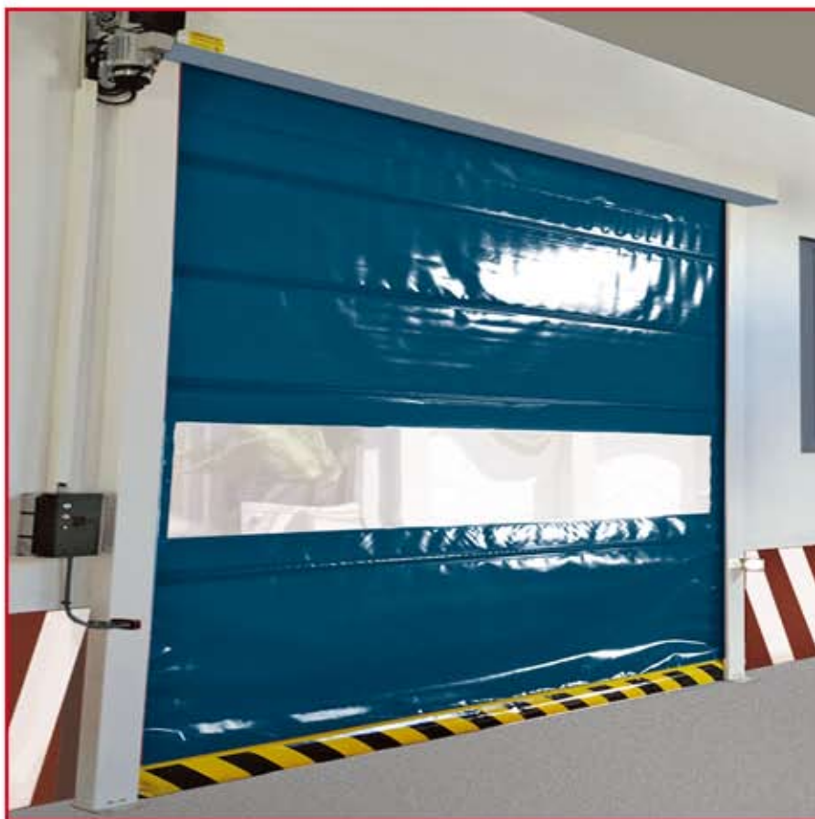
Puerta rápida enrollable, guías y eje de perfilera de aluminio extrusionado, cajón de composite 4 m/m. Lona pvc 900 gr. en color azul.
