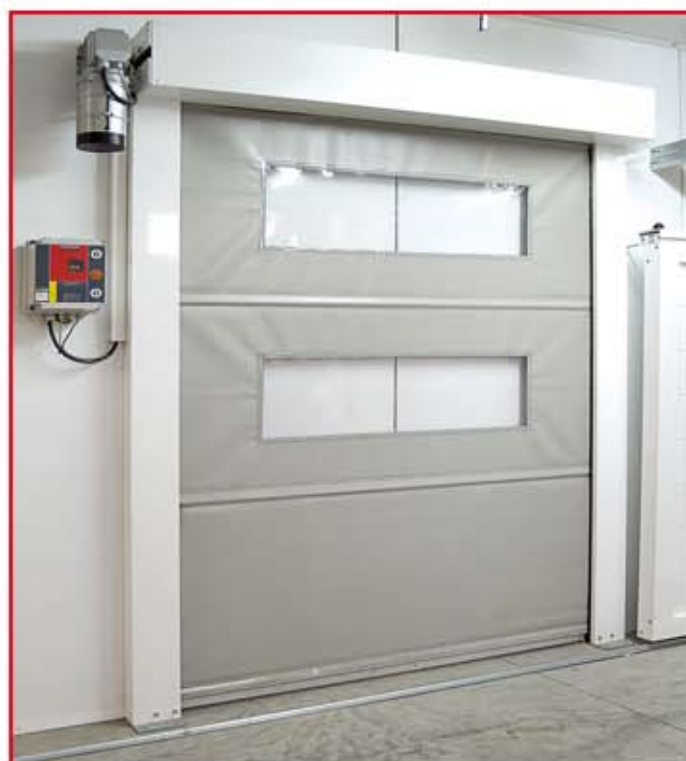
Puerta rápida enrollable, guías y eje de perfilera de aluminio extrusionado, cajón de composite 4 m/m. Lona pvc 900 gr. en color gris.
