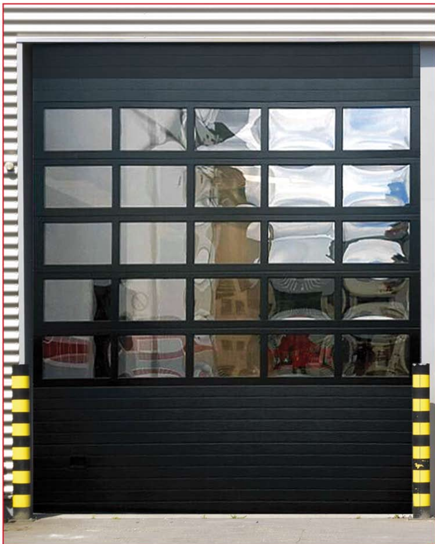
Puerta Seccional Industrial, Panel Acanalado Gofrado Stucco, Secciones Fabricadas con perfiles de Aluminio. Plástico SAN, Lacado en Negro Ral 9011
